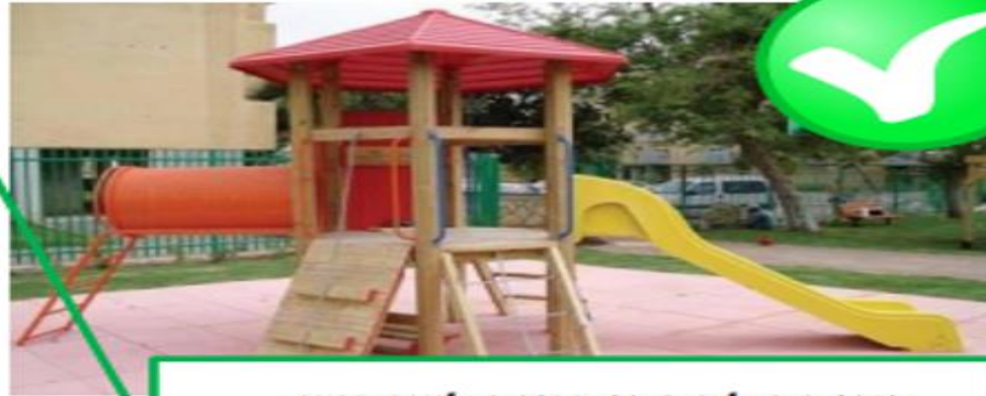
מתקן משחק מתאים לדרישות ת"י 1498. הוצב על משטח סופג אנרגיה, התקנתו בהתאם לדרישות התקן נבחנה ואושרה.
